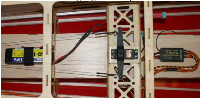
Abbildung 40: Empfänger und -akku
