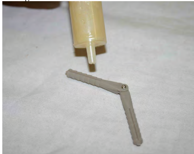
Abbildung 7: Stiftscharnier einkleben a)
