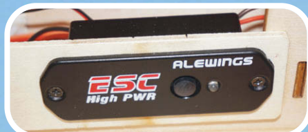
L'interruttore digitale stabilizzato da 15A Alewings
