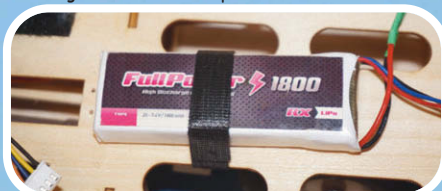
L'impianto radio è alimentato da una batteria FullPower 2S da 1800 mAh
