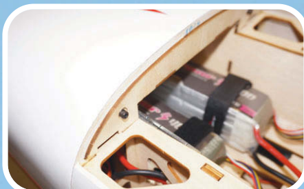
Una delle due viti che bloccano la parte superiore del muso
