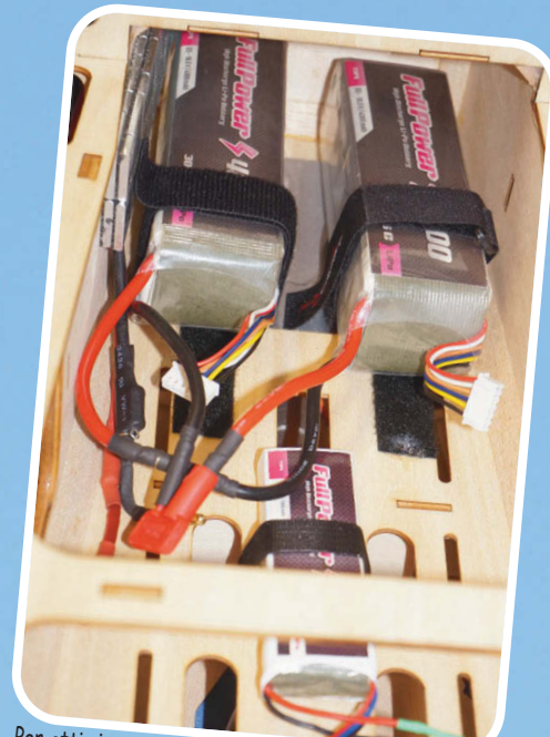
Per ottimizzare il centraggio i due pacchi batterie 5S uniti in serie sono stati posizionati più avanti possibile
