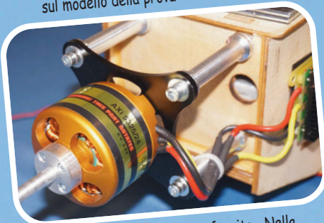
L'ottimo castello motore fornito. Nella foto l'AXI 5325/24 utilizzato per la prova
