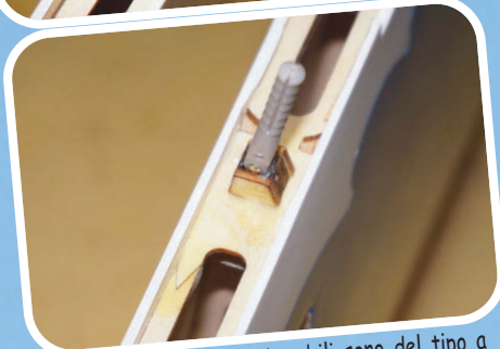
Le cerniere delle parti mobili sono del tipo a spillo, ed hanno delle favolose sedi trapezoidali
