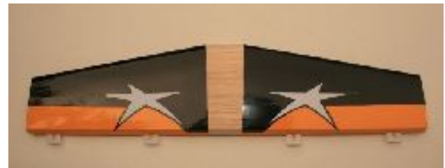
Abbildung 27: Höhenruder Scharniere einkleben
