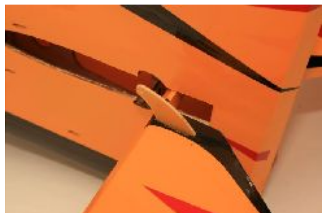
Abbildung 32: Höhenruder einsetzen #3- Ansicht von oben
