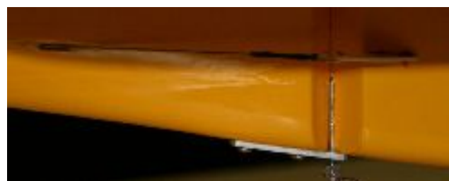
Abbildung 24: Symbolbild Seilanlenkung Sicherung mit Schrumpfschlauch
