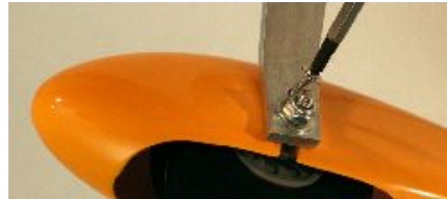
Abbildung 45: Symbolbild Radverkleidung / Verdrehsicherung
