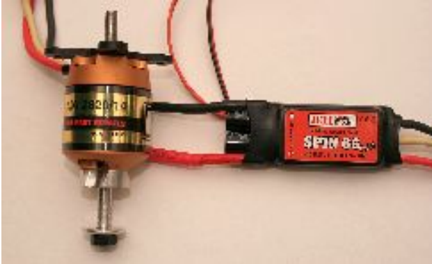
Abbildung 46: AXI 2820/14 und Jeti SPin 66 BEC
