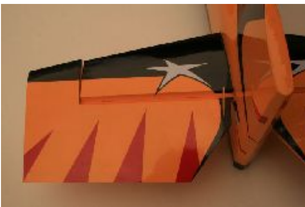
Abbildung 34: Höhenruder / Scharniere einkleben
