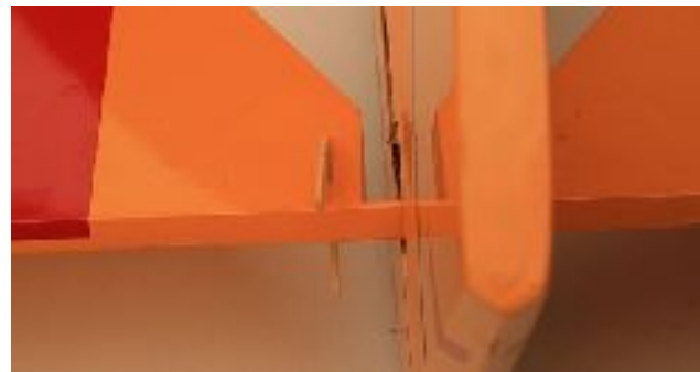
Abbildung 31: Höhenruder einsetzen #2 – Ansicht von unten
